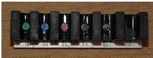
Abbildung 8 (oben): Messlehre zum Kalibrieren der Därme, Werkstatt Frank Smith, Rishton, 2017 (Foto: Jane Achtman)
